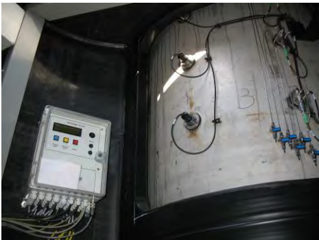
Lysimeter-Behälter mit Sensoren für Messungen in verschiedenen Tiefen und Datenlogger zur Aufzeichnung der Messwerte
